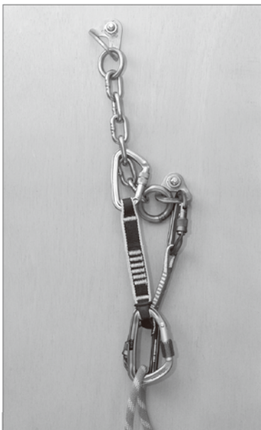
④アンカーを独占しないように、リングはロープを通せる状態にしておきたい。これなら他のクライマーがリングを使える。
