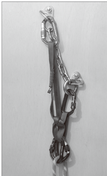
①スリングとカラビナを使って荷重分散した例。下のハンガーにカラビナが通らなければリングにかけてもかまわない。
