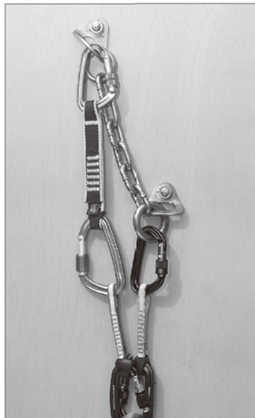
②クイックドロとカラビナを使ったシンプルな例。この場合なるべくゲートの高さが揃うように調整する。
