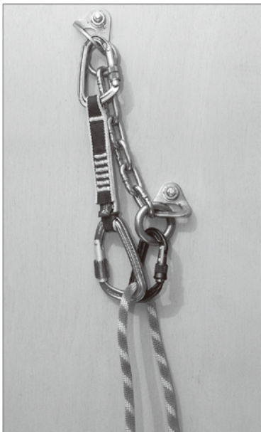
②クイックドロとカラビナを使ったシンプルな例。この場合なるべくゲートの高さが揃うように調整する。
