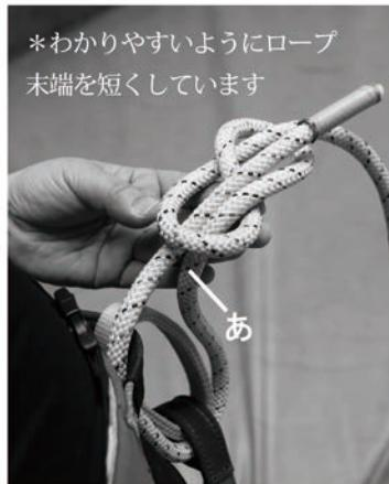
4 次にロープの末端を「あ」の部分の左側に差し込んで、ロープを引く。
