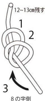
8の字結びは、きちんとキレイに結べていれば、単体でも信頼性の高い結びめですが、仕上げにロープ末端側を「止め結び」をすることを推奨しています（コンペ参加者は国際ルールにより、止め結びが義務付けられています）。方法は左図のようにメインのロープに8の字結びから出たロープの末端を自分から見て外側から2重に巻き、3重目を下から通して、最後に絞るように締め上げて、完成。この時、ロープ末端が12~13cm（ひと握り半）出しておく長さが適当です。
