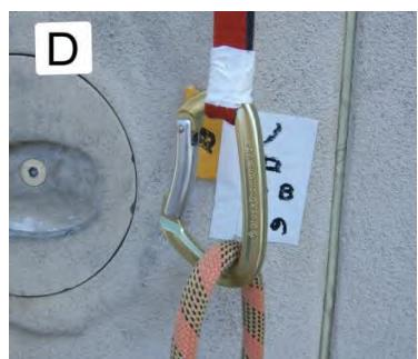
さらに「横向き荷重（原文は”cross loading”）となる可能性が、極力少なくなるようにすること。」とあるのは、カラビナの短軸方向への荷重（写真 B）を指します。カラビナが回転して中途半端なところに引っかかった状態で荷重がかかることがないように、テープや専用のゴム輪などで固定しておけ（写真 C、D）、ということでしょう。
